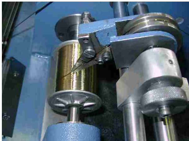
Rohový typ vedení drátu pro vinutí drátu z pružinové oceli
